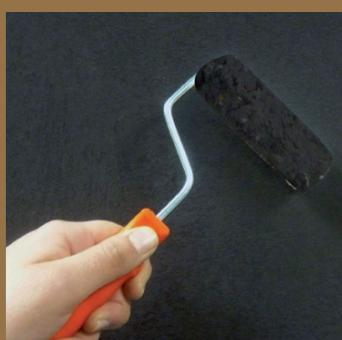
Aplicar la primera capa de OXITEM al uso sobre la imprimación. Aplicar una segunda capa de OXITEM al cabo de 1 - 2 horas después, a fin de asegurar una correcta aplicación. Aplicar preferentemente con paletina ancha.
