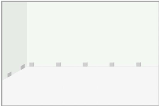
Una vez cortados los elementos de suelo de la primera hilada al ancho establecido, se orientarán preferiblemente con el canto que lleva la lengüeta (canto macho) hacia la pared y se instalarán de izquierda a derecha según su sistema de unión:
