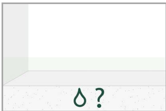
La medida del contenido de humedad se realizará a una profundidad aproximada de la mitad del espesor de la solera, y en todo caso a una profundidad mínima de 2 cm, según norma UNE 56810:2004. Este contenido de humedad se puede estimar empleando un higrómetro adecuado para este uso, o bien se puede determinar más exactamente extrayendo muestras, desecándolas en estufa a 70 °C y calculando el contenido de humedad por diferencia de pesadas.
