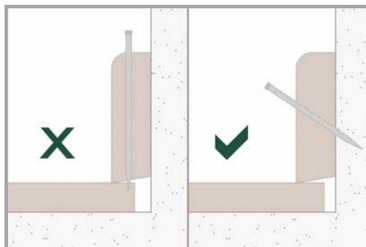
El sistema de fijación del rodapié a la pared puede ser mediante atornillado, clavado, etc. En todo caso, se seguirán las instrucciones del fabricante e este respecto.
