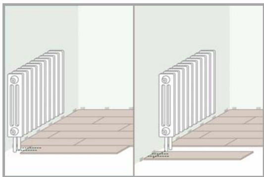
Se recortará posteriormente la pieza de modo que los orificios queden separados por su eje y en dos piezas.
